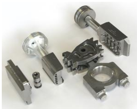
Figura 6 - Principais componentes modificados com a tecnologia VCRI. Da esquerda para a direita: parede com cremalheira; rolo sincronizador; pistão com haste cremalheira; biela com "gearwheel"; pistão atuador com haste cremalheira [8].
